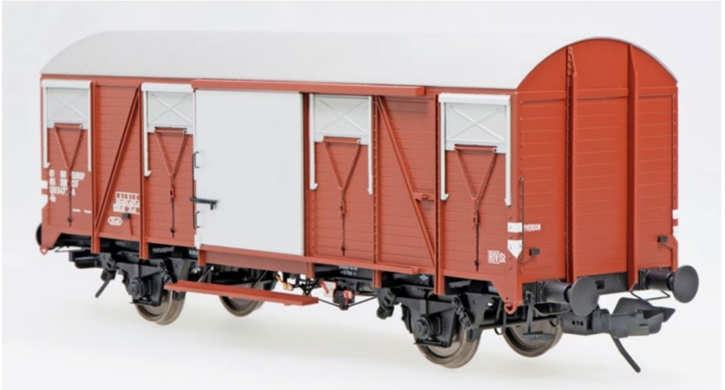
Verbretterte Seitenwände, durchgehendes Trittbrett im Bereich der Schiebetüren, Lüfterschieber und Schiebetüren in Aluminiumoptik, selbst die ...
