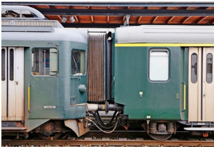
Nettes Detail: der Faltenbalg des BDe 4/4 1641 verbunden mit dem Gummiwulst des A 524.
