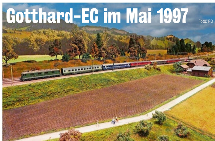
Triebfahrzeug: Re 6/6, 7,8 MW, 120 t, Last: 40 Achsen, 586 Plätze, 459 t, V max: 140 km/h.
