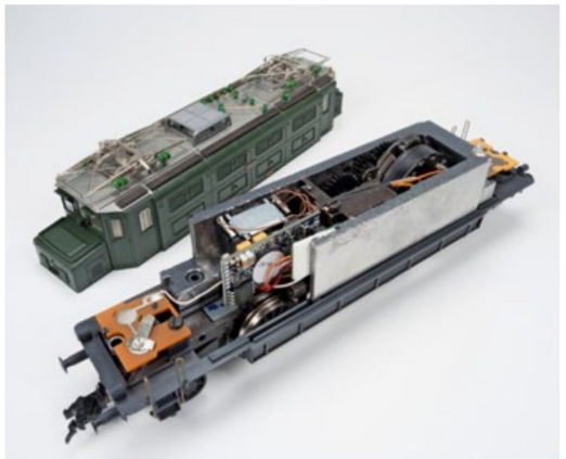
... zu gross. Abhilfe schafft ein Lautsprecher von Zimo, der ohne Fräsen passt.
