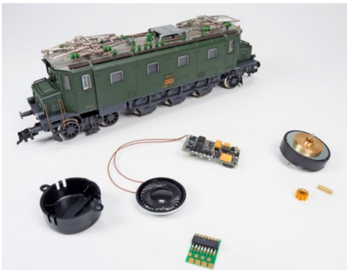
Bereit für die Revision: neuer Motor, Decoder mit Lautsprecher und eine Adapterplatine für den Decoder.
