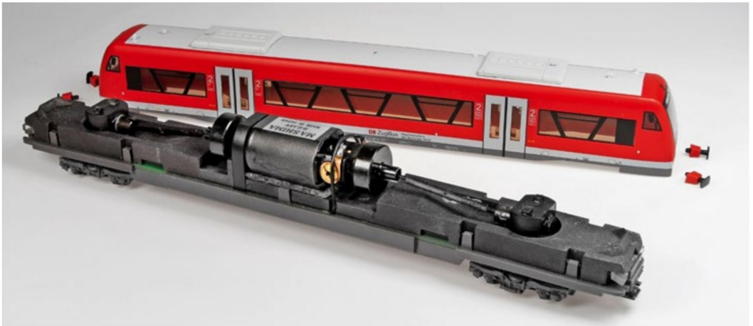
Die Abnahme des Kunststoffgehäuses geht relativ leicht. Das Modell ist so für den im Folgenden beschriebenen Einbau eines Decoders parat.
