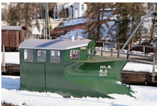
Die Typenansicht zeigt die seitlichen Blechplatten zur Schneeprofilierung.
