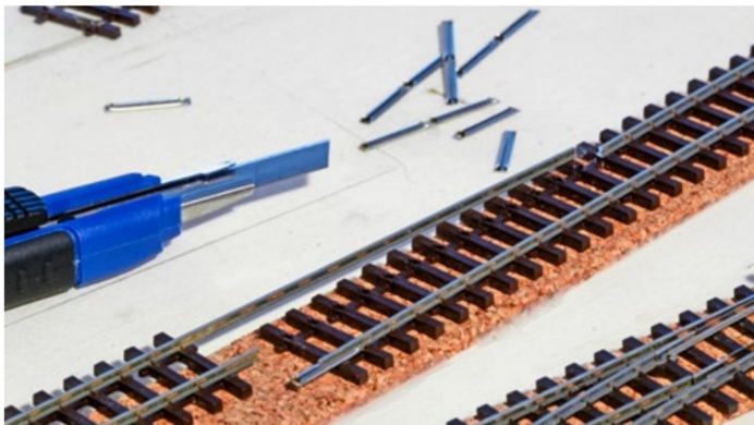
Der Versatz der beiden Gleisprofile beim Verbinden zweier Schienenstücke sollte ca. 6 cm betragen. Beim einen Stück werden die Schwellen belassen. So kann das lange Profil des linken Gleises in die Schienenstühle der Schwellen eingeführt werden.
