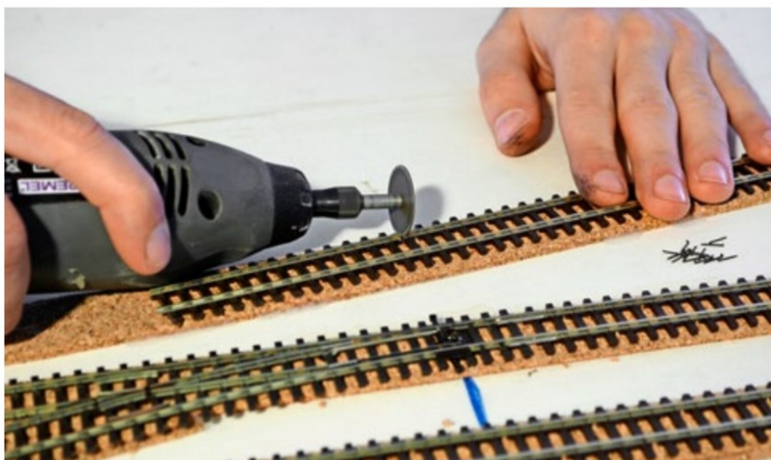
Versetztes Trennen eines Gleisstücks. Ein Dremel mit Trennscheibe ist ein grossartiges Tool beim Gleisbau.
