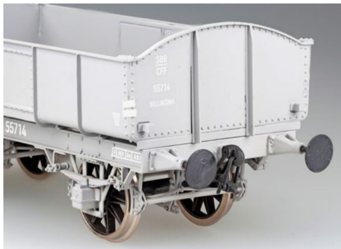
Auf der Stirnwand der hinteren Wagenseite ist ein Anschriftenfeld mit der Wagennummer aufzubringen.
