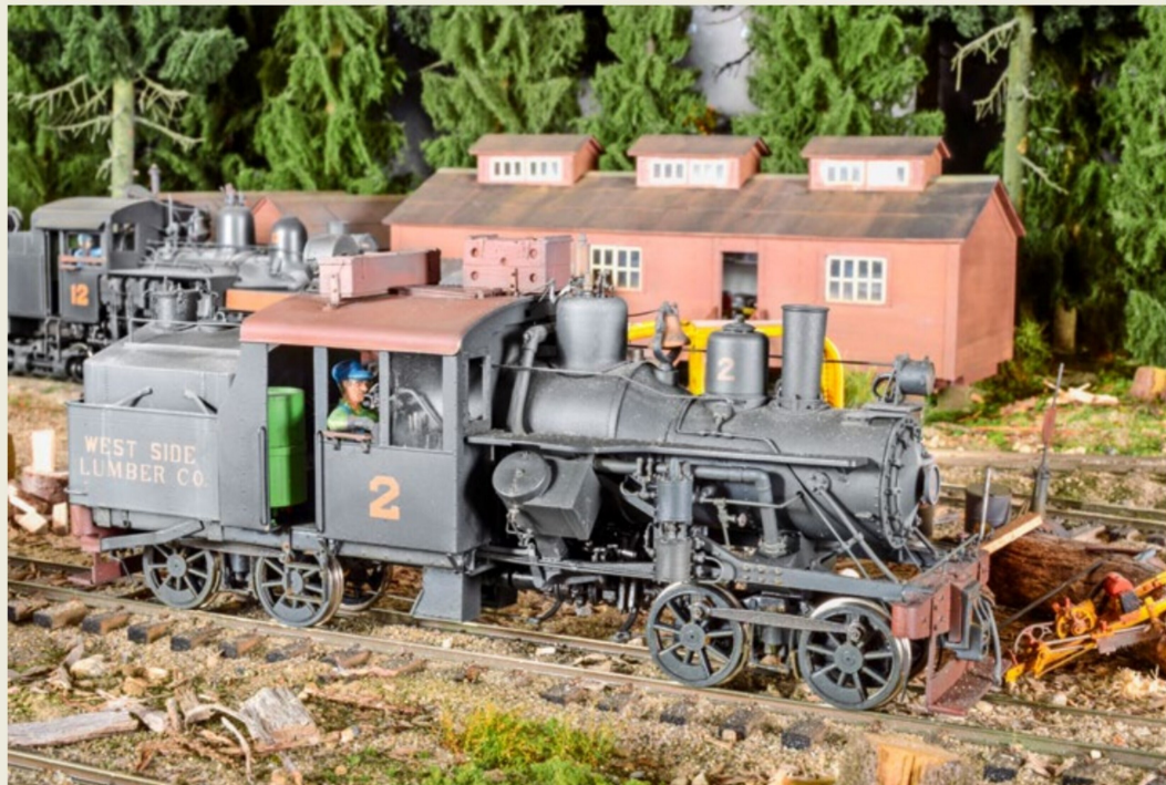
Die beiden Aussenzylinder der Heisl übertragen ihre Kraft auf eine Kardanwelle, die ihrerseits zu den Drehgestellen führt.
