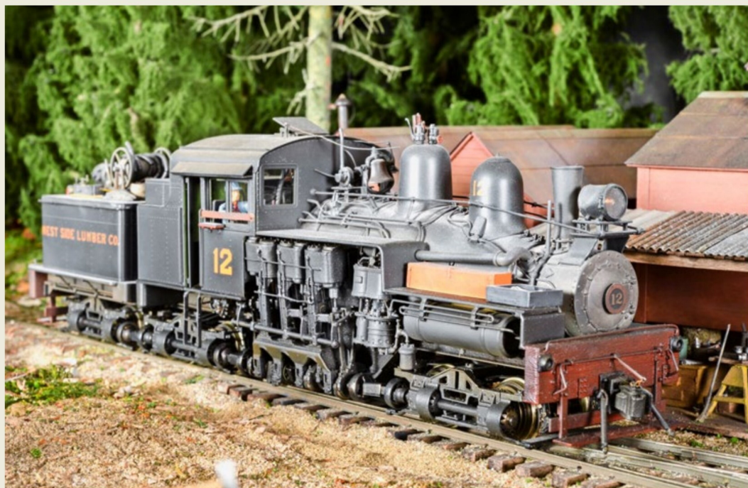
Die Shay-Lokomotiven mit ihren Gelenkantrieben zeichnen sich durch hohe Zugkraft und ausgezeichnete Kurvengängigkeit aus.
