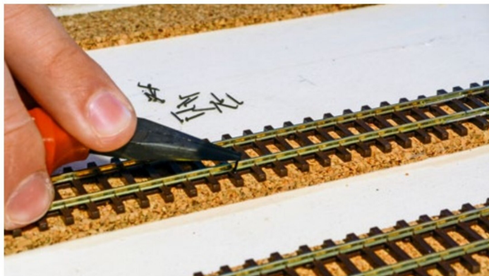
Nageln der Gleise. Die Nägel werden mit einer kleinen Zange gehalten, um sie über der Flamme eines Feuerzeugs zu erhitzen und dann durch die Kunststoffschwellen zu drücken.
