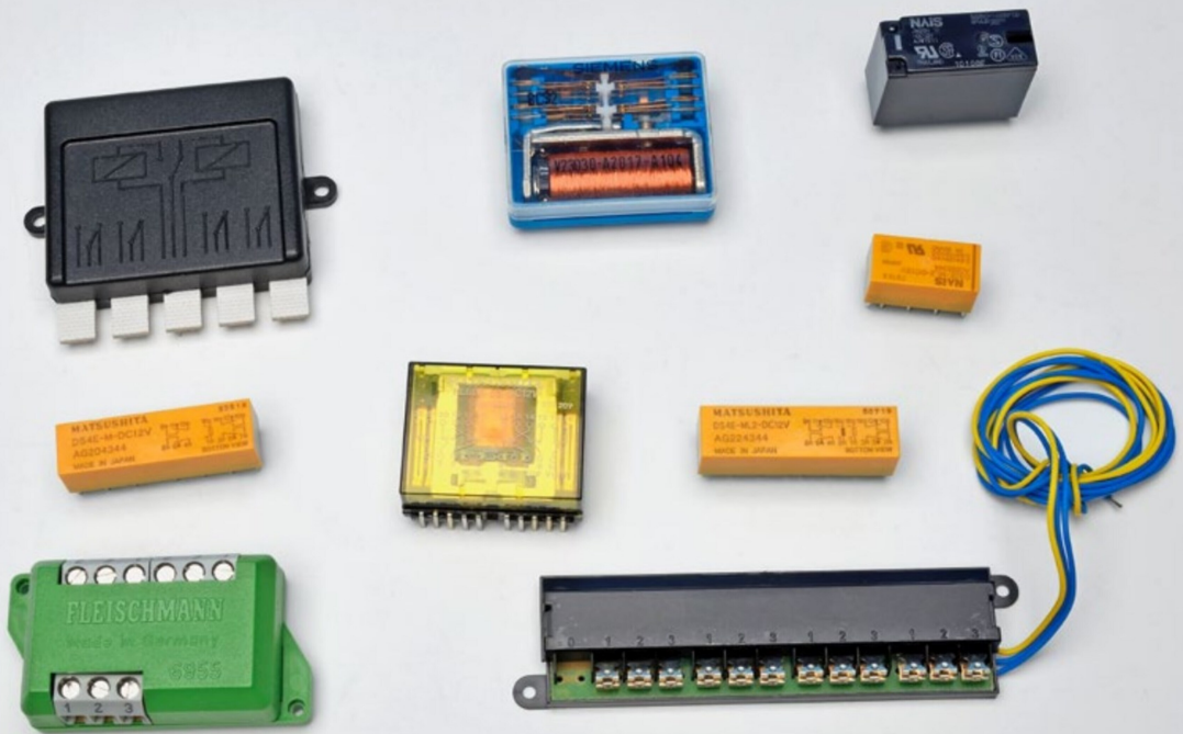
Hier abgebildet sind Relais der Modellbahnhersteller (Fleischmann, Märklin und Roco) sowie Industrieprodukte.
