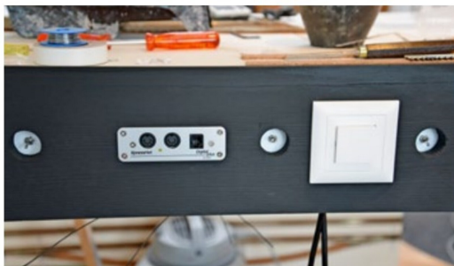
Kippschalter für die Weichenantriebe und der Hauptschalter (engl. Master Switch).
