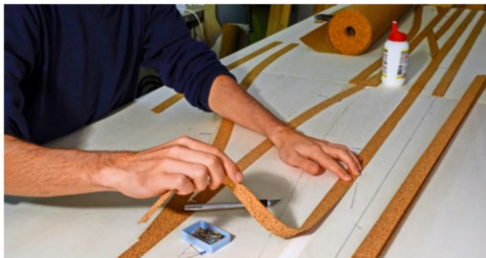
2 mm dicke Korkbahnen werden aus einer grossen Rolle zugeschnitten und mit Weissleim verklebt. Als Hilfe dient der auf die Oberflächenplatte gezeichnete Gleisplan.
