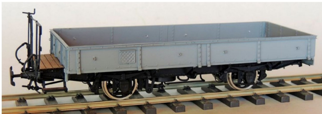
Designstudie des M-Wagens, fein geätzte Ausführung ganz aus Messing für die 0m-Fine-Scale-Gleise.
