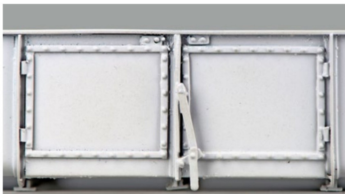
Detailaufnahme der seitlichen Türen. Gut zu erkennen sind die Türrahmen und der Verschlussmechanismus.
