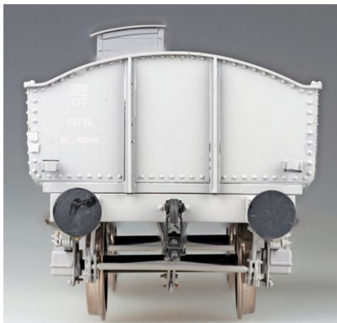
Totale der Stirnwand. Gut zu erkennen sind die Nietenreihen entlang der Aussenkanten.
