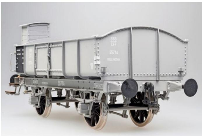
Gut zu erkennen: die Details des Oberteils mit dem vorgebogenen Boden und dem Stirnteil.
