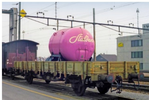
Ein CTW, beladen mit einem Stalder-SCC, abgestellt im Konolfinger Freiladegleis. Der SCC ist übrigens auch längs zur Fahrtrichtung verladen.
