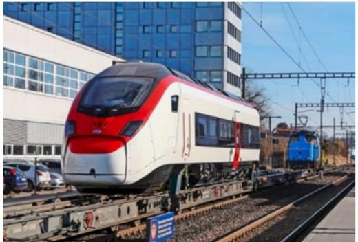
Für den Transport der Giruno-Wagenkästen zwischen Bussnang und Erlen greift Stadler auf eine schienengebundene Logistiklösung zurück.
