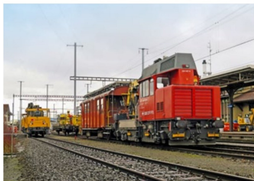
Während der Demontage der Fahrleitungsanlage in Bereichen des Bahnhofs Konolfingen kamen die Fahrzeuge Tm 234 207-9, Xs 40 85 95 48 163-6, XTmass 99 85 9236 088-2 sowie ein zweischiger Xtm zum Einsatz.
