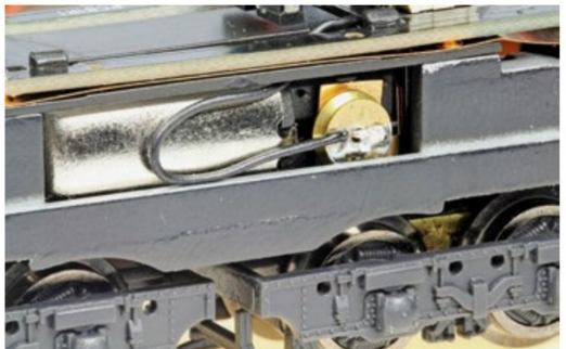
Hat etwas «Hemdsärmeliges»: die Lötstelle zum Anschluss des Motors.
