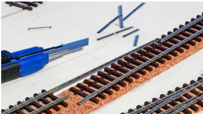
Der Versatz der beiden Gleisprofile beim Verbinden zweier Schienenstücke sollte ca. 6 cm betragen. Beim einen Stück werden die Schwellen belassen. So kann das lange Profil des linken Gleises in die Schienenstühle der Schwellen eingeführt werden.
