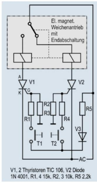
Ein elektromagnetischer Weichenantrieb ist vergleichbar mit einem bistabilen Relais.
