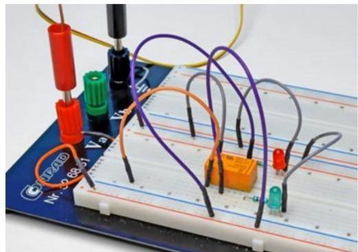
Vor der praktischen Anwendung eines Relais sollte man sich durch eine Testschaltung über die Kontaktbelegung vergewissern. Die orangefarbene Leitung ist im linken Bild mit dem Pluspol verbunden, es leuchtet die grüne LED.
