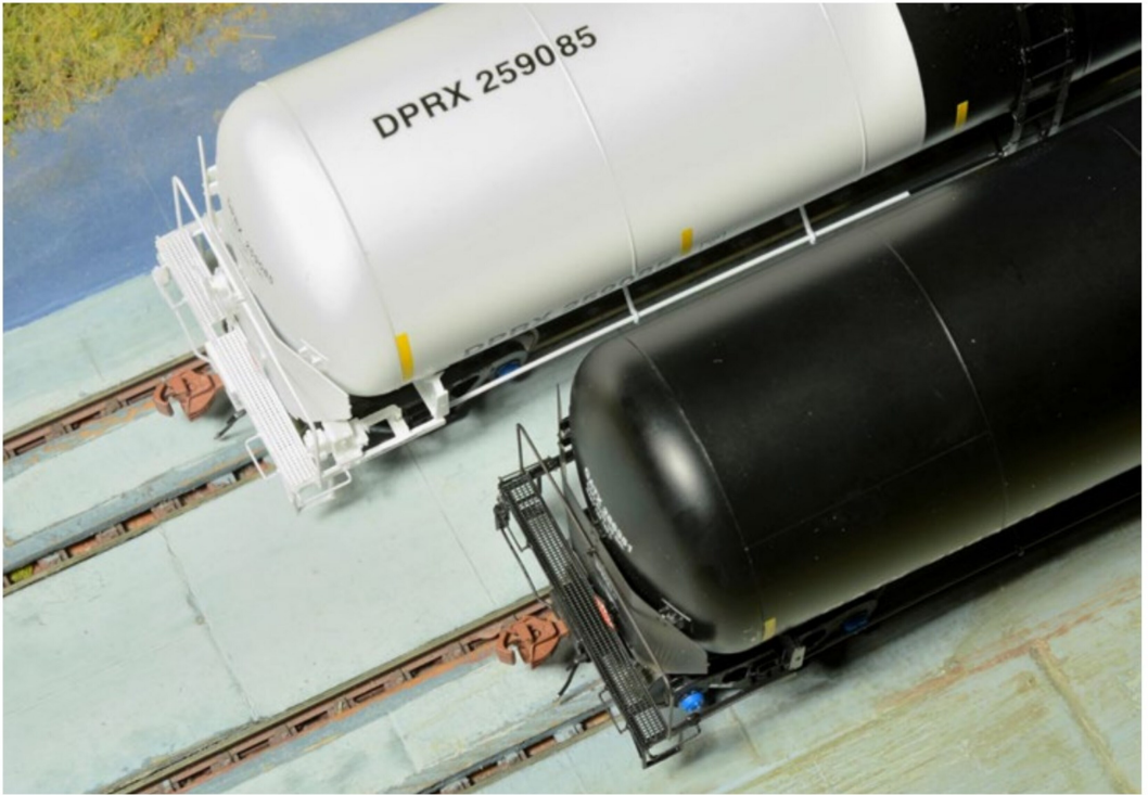
Erst ein direkter Blick von oben lässt die feinst durchbrochenen, aus Ätzblechen eingesetzten Bühnen an den Wagenenden erkennen.
