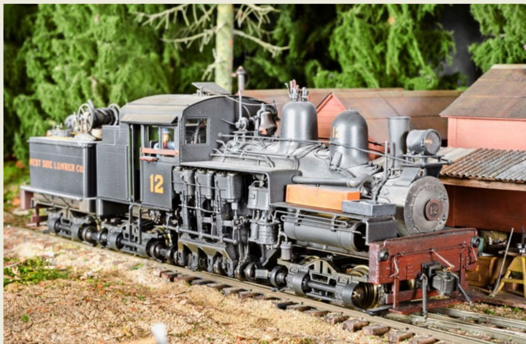
Die Shay-Lokomotiven mit ihren Gelenkantrieben zeichnen sich durch hohe Zugkraft und ausgezeichnete Kurvengängigkeit aus.
