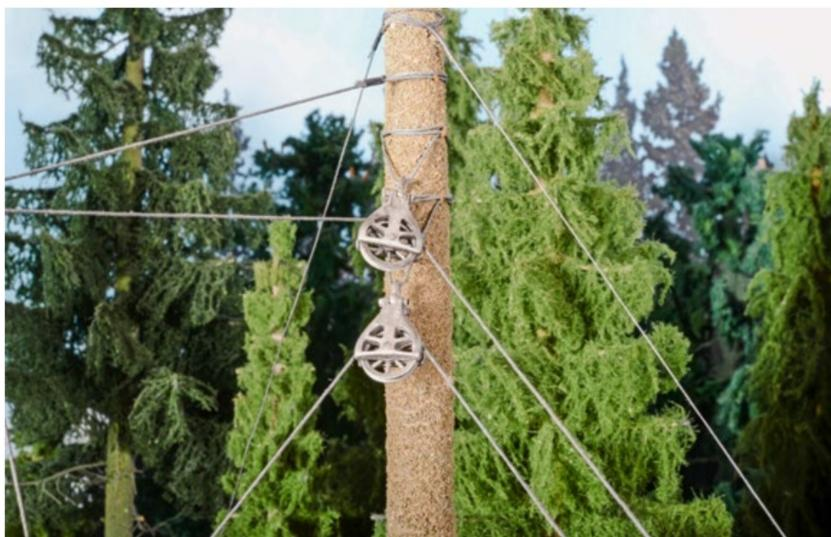
Zusätzlich sind auch Abspannungen der Stämme notwendig, damit sie den Belastungen durch das Ladegut standhalten.
