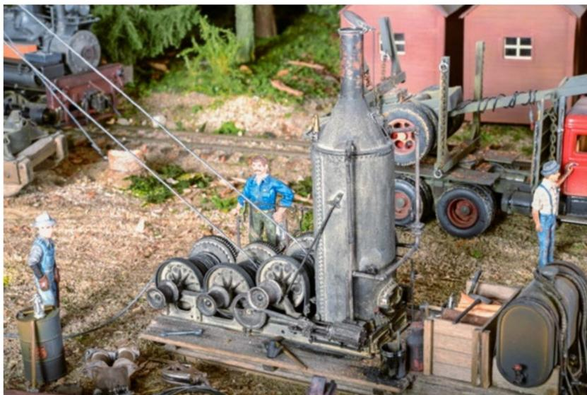
Mit dieser Dampfwinde («Wide Face Donkey») wird der improvisierte Kran angetrieben. Sie verfügt über drei Seilwinden.
