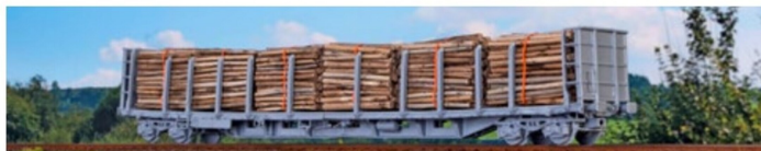
Ein Holztransportwagen vom Typ Rnoos uz-3523 für den internationalen Verkehr in der Epoche VI.
