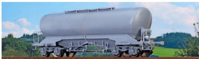
Ebenfalls eine komplette Neuentwicklung der Uacns 932, ein Silowagen für den Zementtransport.
