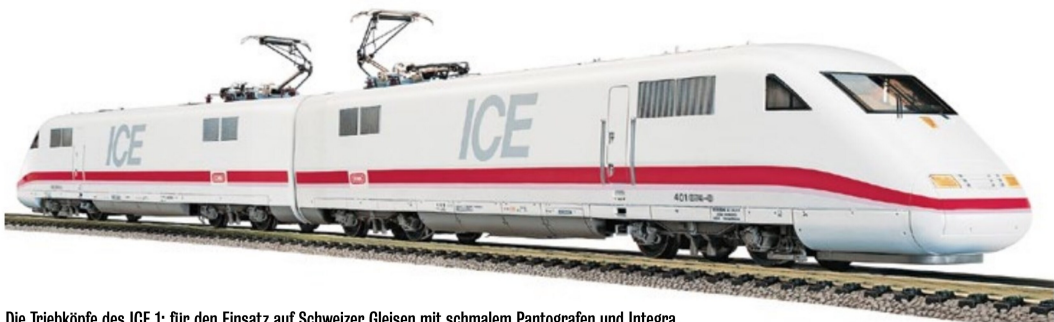
Die Triebköpfe des ICE 1: für den Einsatz auf Schweizer Gleisen mit schmalen Pantografen und Integra.
