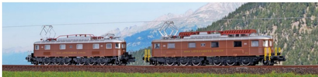
Zweimal BLS Ae 6/8, zweimal mit der Betriebsnummer 205. Einmal mit einem Pantografen, einmal in der Ursprungsausführung mit zwei Pantografen.
