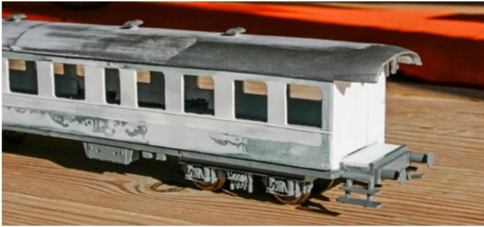
Die offene Plattform erhielt einen neuen, aus Polystyrol gefertigten Bretterboden. Am Schluss wird noch ein Geländer von Born die Plattform vervollständigen.
