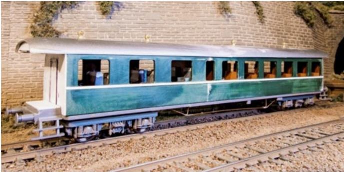
Der rohe, aber bereits fertig umgebaute Wagenkasten des AB 113. Deutlich sieht man die Schnittstelle.
