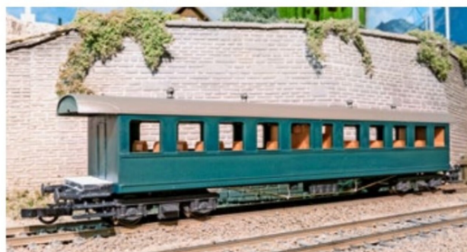
Der Wagenkasten und das Dach mit den neuen Lüftern und dem Farbanstrich.
