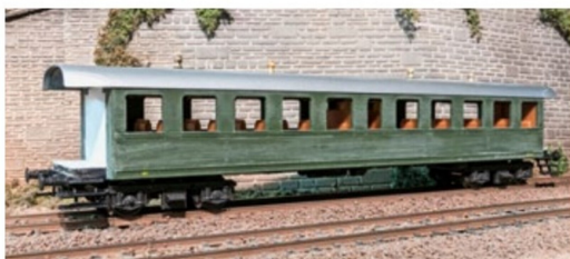
Der abgeschliffene Wagenkasten mit der neuen Einstiegsplattform.
