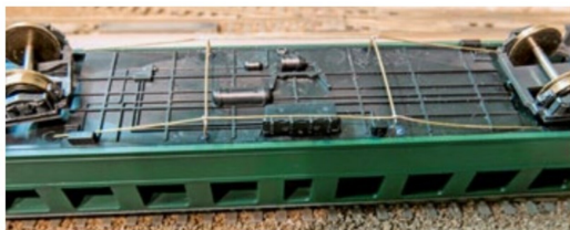
Blick auf den Unterboden. Gut sichtbar die Konstruktion des Sprengwerks.
