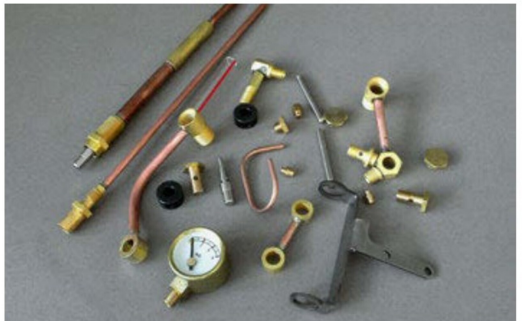
Regler und Hilfsbläser ganz links und weitere Teile für die Kesselrückwand.
