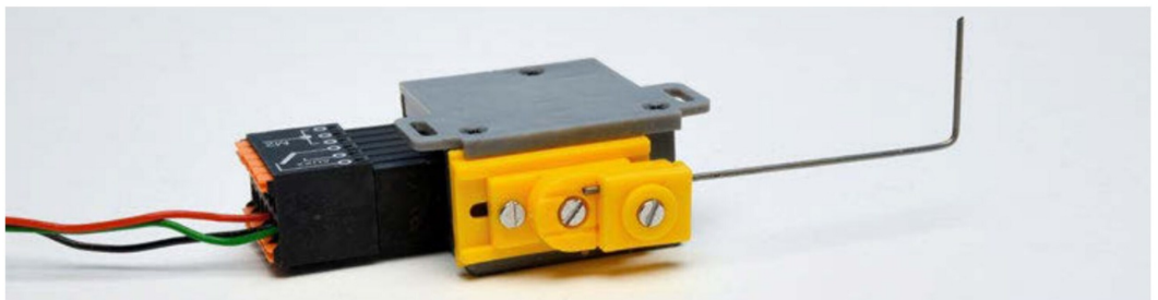
Lässt sich aus Platzgründen der Antrieb nicht direkt unter der Stellschwelle platzieren, kann das Zusatzteil, das der Packung beiliegt, eingesetzt werden. Je nach Abstand ist ein längerer Stelldraht mit geeignetem Durchmesser zu verwenden.
