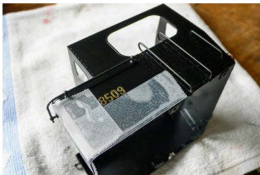
Klebestreifen als Anschlag helfen beim Aufkleben der Messingzahlen.
