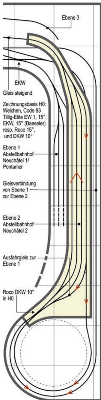
Die asymmetrische Dreiwegweiche ist durch normale Linksweichen zu ersetzen.
