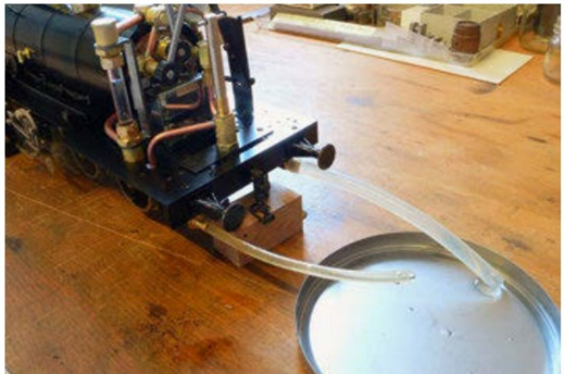
Lok läuft mit Luft: Test der Wasserpumpe und des Bypassventils.
