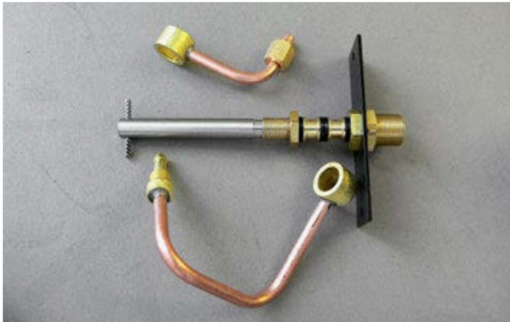
Kommt später ins Führerhaus: das Steuerventil für die Achspumpe.
