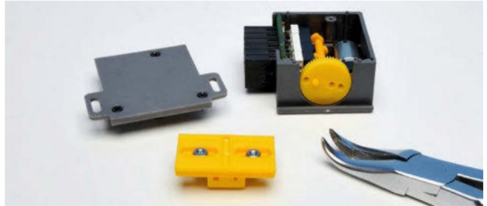
Zur Einstellung des Stellwegs ist die Grundplatte zu entfernen und der kleine gelbe Bolzen abzuziehen und in der gewünschten Position einzustecken. Beim Abziehen sollte das Zahnrad mit dem Daumen festgehalten werden.
