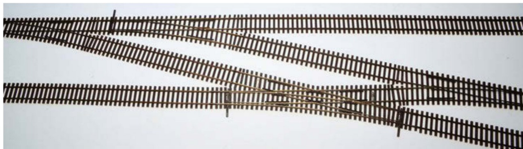
Die Verzweigung nach der Ausfahrt aus dem Abstellbahnhof Neuchâtel 1/Pontarlier in H0 mit Tillig-Elite-Code-83-Gleismaterial. Die Weichen sind EW-1-Typen mit 15°-Abzweigwinkel und einem Abzweigradius von 866 Millimetern. Das wichtigste Gleiselement ist die EKW (Einfache Kreuzungsweiche vom Typ Baeseler mit einem Radius von 1050 Millimetern. Sie garantiert grösstmögliche Sicherheit beim Befahren mit längeren Fahrzeugen.
