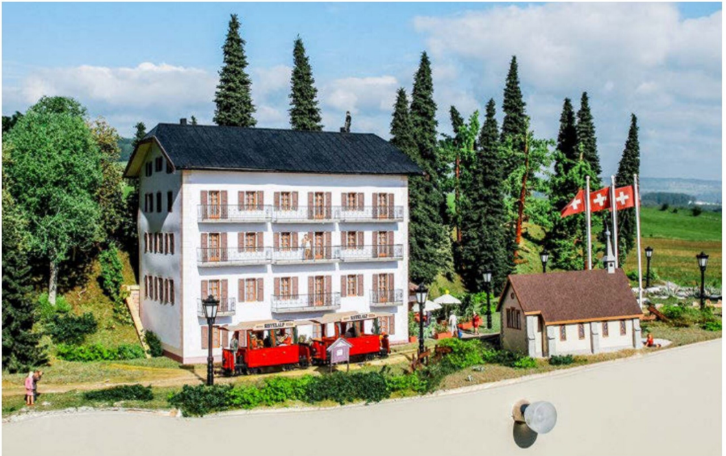
Die Fassaden der Gebäude bestehen aus verschieden starkem Karton. Die Brüstungsgeländer sind auf transparente Folien aufgedruckt.
