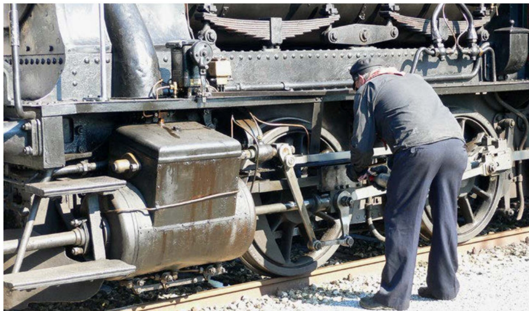
Das ist Dampfbetrieb: Im Grossen wie im Kleinen braucht die DampfloK Pflege. Abschmieren des Gestänges im Bahnhof Triengen im September 2016.
