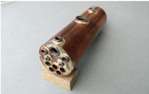
Der Kessel von der Rückseite her: Fünf Rauchrohre sorgen für Leistung.
