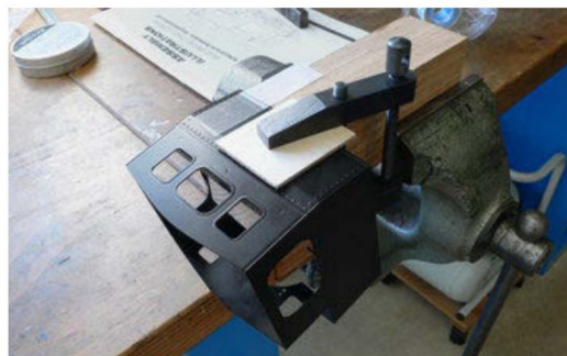
Bohren der Löcher für die Zusatzteile, eine gute Befestigung ist wichtig.
