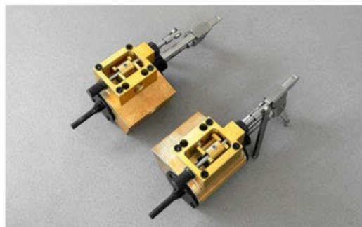
Schrauben in den Ecken der Schieberkästen halten auch die Zylinderdeckel fest.
