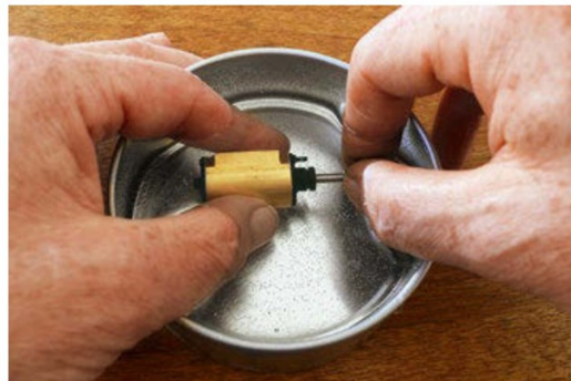
Eingeschlossene Luft hin- und herdrücken zeigt, ob die Zylinderdeckel dicht sind.
