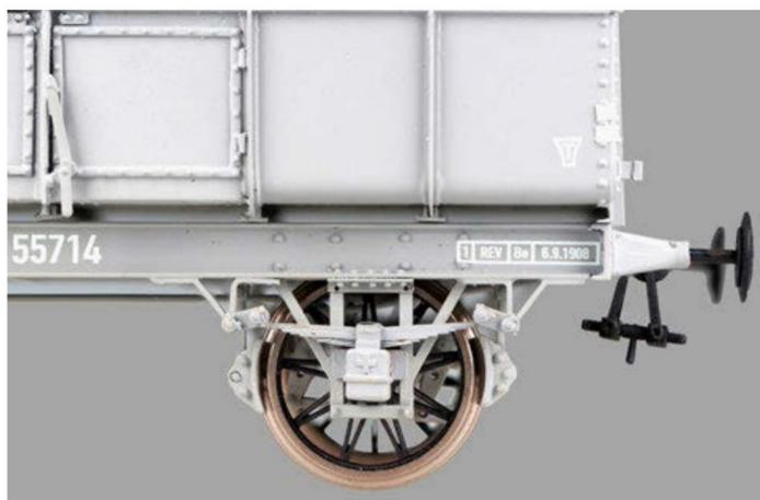
Detail des Achslagers mit den Federpaketen, den Schakenböcken und den Achslagerführungen.
