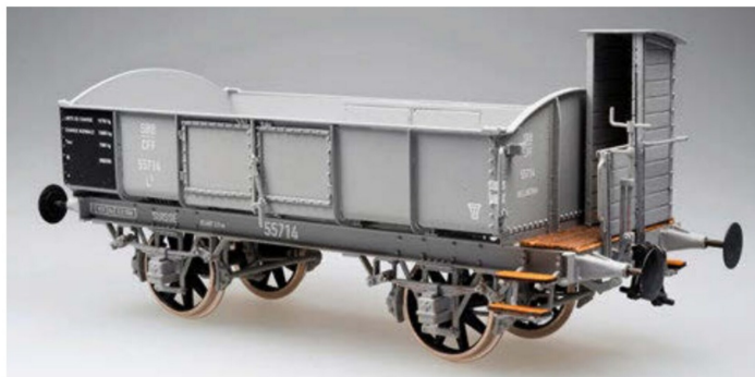
Das Modell ist überwiegend aus Ätz- und wenigen Gussteilen zusammenzubauen.
