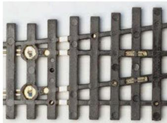
Die Unterseite einer HO-Peco-Code-75-Weiche. Für den sicheren Digitalbetrieb sind die beiden kleinen Strombrücken im Bild rechts zu entfernen und an den werkseitig freien Flächen im Schwellenrost links und rechts jeweils eine Brücke einzusetzen.
