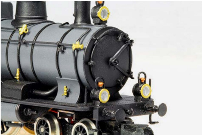
Die drei Lampen der Spitzensignale sind bewusst mittels Mikroglühlampen ausgeleuchtet worden.
