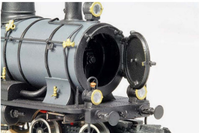
Für die leider unvermeidlichen «Einsätze» im Lokdepot lässt sich die Rauchkammertüre öffnen.
