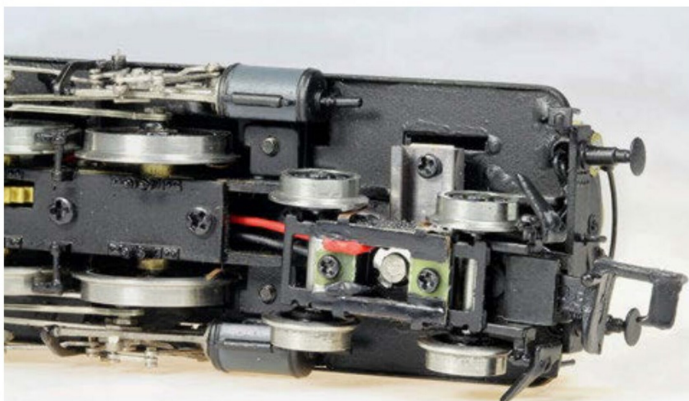
Auch die vier Räder des Vorlaufgestells werden für die sichere Fahrstromaufnahme mitverwendet.
