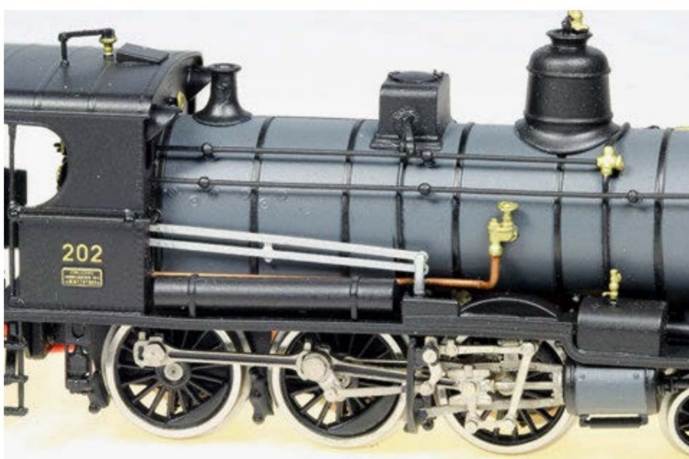
Nicht nur schön, auch funktionell. Die feinen Triebstangen sorgen für den Antrieb der Treibachsen.
