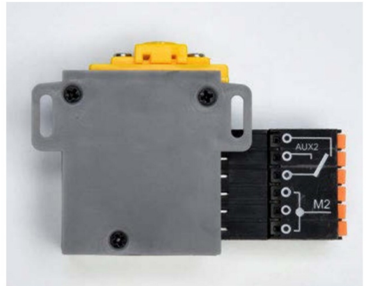
Die Rückseite des MP 5 und seine Steckerbelegung.
