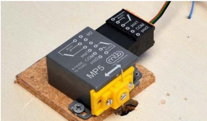
Der MP 5 wurde beim Test auf einer 5 mm starken Korkunterlage montiert. Der Stelldraht aus Messing hat einen Laufweg von 6 mm, um eine HO-Tillig-Elite-Weiche umzustellen.
