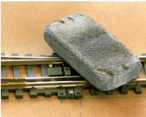
Nach dem vollständigen Durchtrocknen der Farbe kann mit einem Schienenreinigungsgummi die Farbe von den Schienenköpfen gerubbelt werden. Diese Reinigungsgummis wirken wie kleine Schleifklötze. Betrachtet man die Schienenköpfe nach der Reinigung mit der Lupe, erkennt man feine Riefen. In denen kann sich später Staub und Abrieb absetzen und zu Kontaktsschwierigkeiten führen. Je feiner der Schleifgummi ist, desto besser ist er für das Gleis.
