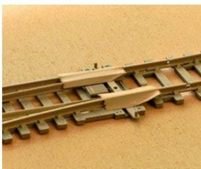
Nach dem Lackieren sind auch die Köpfe mit Farbe bedeckt. Schiene und Schwellen haben den gleichen Farbton. Wem dies nicht gefällt, der kann den Schwellen mit einem zweiten Farbauftrag eine etwas andere Tönung geben. Der Auftrag erfolgt wieder mit einer Sprühdose (oder der Airbrush), diesmal sollten aber genau senkrecht von oben auch das Gleis und die Schwellen gespritzt werden. So gelangt fast keine Farbe an die Flanken der Schienen.
