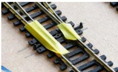
Der Streifen des Maskierbandes an einer HO-Weiche sollte auf alle Fälle mindestens auf die Länge der anliegenden Zunge plus etwa einen halben Zentimeter vor der Zungenspitze und etwa einen nach dem letzten Berührungs punkt an der Schiene abgeklebt werden. Ein kurzer Streifen wie an der oberen Schiene reicht nicht aus.
