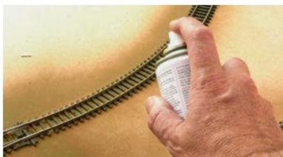
Das Lackieren selbst kann mit mattem Lack aus einer Sprühdose erfolgen. Wichtig ist, dass die Schienenflanken auch im Bereich der Kleineisen gleichmässig lackiert werden. Hierzu sollte man einmal von links und einmal von rechts entlang der Schienen sprühen.
