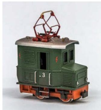
Die neue ergänzt das Sortiment der Feldbahnlokomotiven. Mit einer Länge von 43 mm ist sie wahrlich kein Riese, aber durch das in der neuen Messingfeinguss-technologie ausgeführte Gehäuse und das daraus resultierende hohe Betriebsgewicht im Verbund mit dem Universalfahrwerk hat die Kleine hervorragende Laufeigenschaften. Selbst komplizierte Weichenverbindungen können sicher befahren werden.
