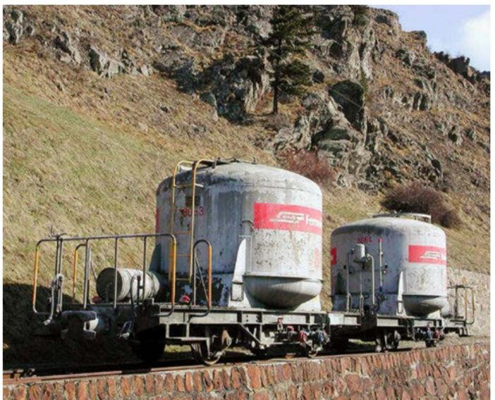
Die Abstützungen der Kessel und die Lage der Druckluftkessel sind bei der ersten Serie nicht einheitlich.
