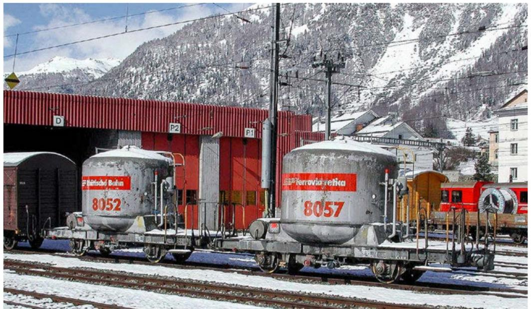
Die beiden sind auch «Mohrenköpfe», allerdings aus der ersten Serie mit der auch unten runden Kesselform und einem Ladevolumen von lediglich 11,2 m<sup>3</sup>.
