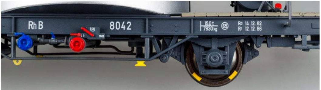
Sämtliche Beschriftungen beider Varianten sind einwandfrei und trennscharf ausgeführt. Auf den Radreifen sind die Kontrollmarkierungen aufgedruckt.
