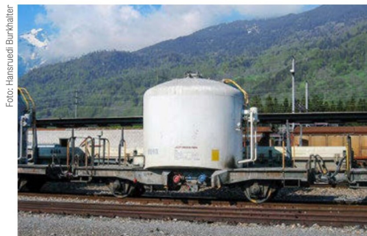
Wagen aus der letzten Bauserei mit Längsträgern in Fischbauchausführung.
