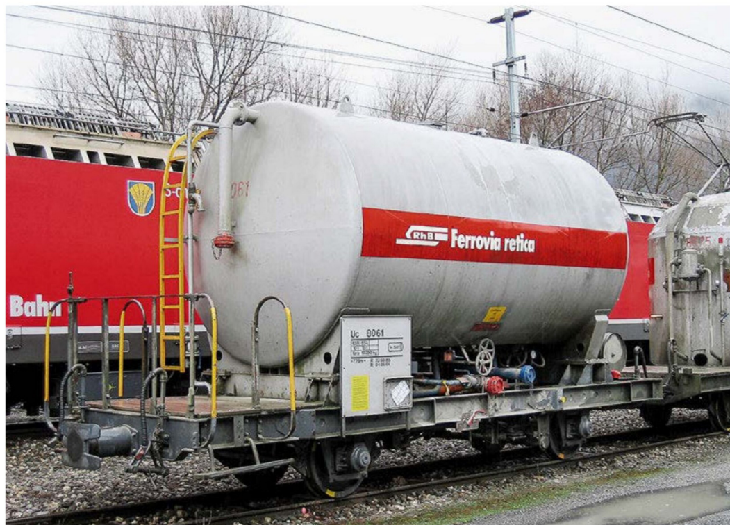
Ebenfalls aus der ersten Serie stammt dieser Wagen mit liegendem, zylindrischem Kessel. Von dieser Ausführung gab es nur zwei Exemplare.
