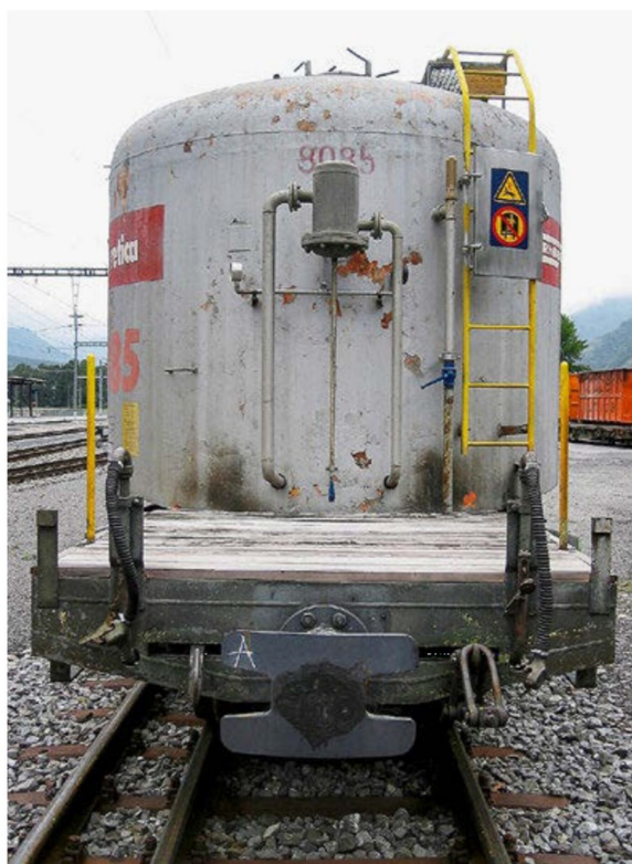
Blick auf die Aufstiegsleiter zur Füllöffnung mit dem Aufstiegsschutz.
