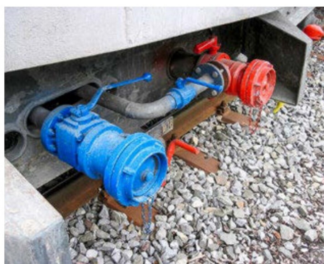
Ventile und Anschlüsse für die Befüllung und Entleerung.
