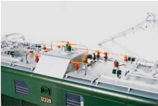
Die Dachpartie der B3 4/6 mit farblich richtigen Isolatoren und Dachleitungen.
