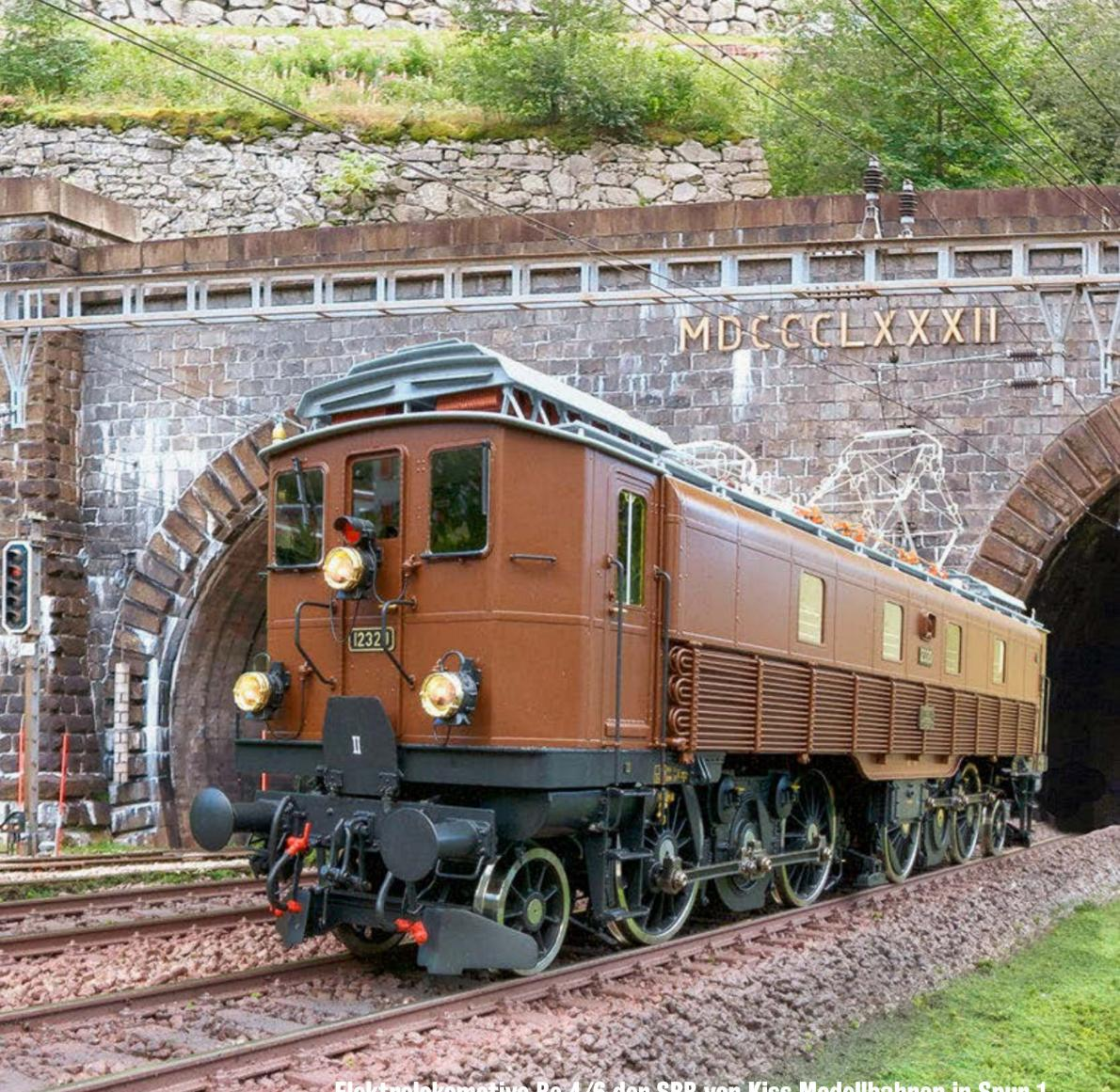
Elektrolokomotive Be 4/6 der SBB von Kiss Modellbahnen in Spur 1
