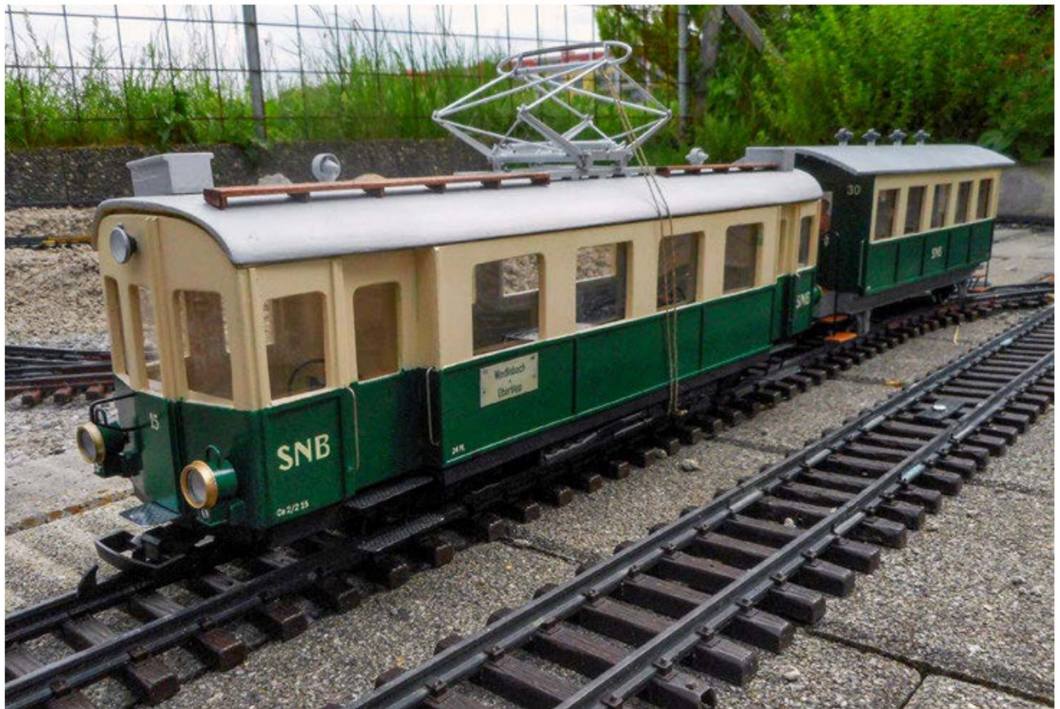
Wie bei den Bahnen üblich: die obligate Werksaufnahme. Man beachte das typische Zugseil für den Pantografen.
