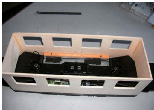
Sichtbar: die Befestigung des Kastens auf dem Fahrgestell.
