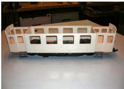
Der Gehäuserohbau mit den angesetzten Führerständen.
