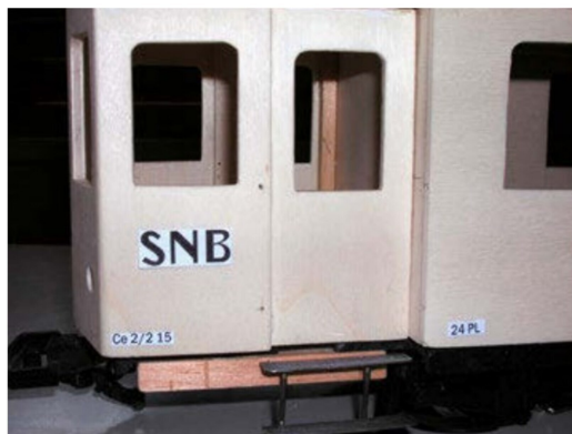
Wichtig: der am Fahrgestell montierte Holzblock zur Montage der Treppen.
